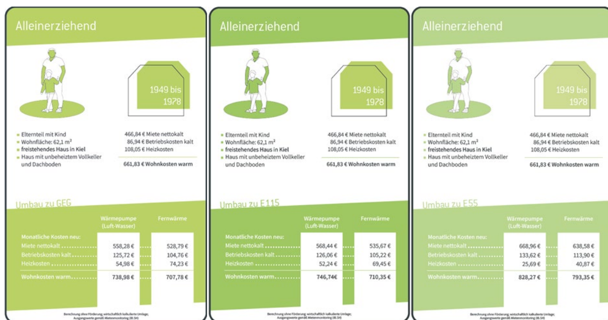
Abbildung 87: Vergleich der Auswirkungen unterschiedlicher Sanierungsambitionen (steigend von links nach rechts) sowie des Anschlusses an ein Fernwärmenetz im Vergleich mit der Installation einer Wärmepumpe auf die Nettokaltmiete, die Betriebskosten und die Heizkosten eines alleinerziehenden Elternteils, wohnhaft in einem Mehrfamilienhaus (48).
