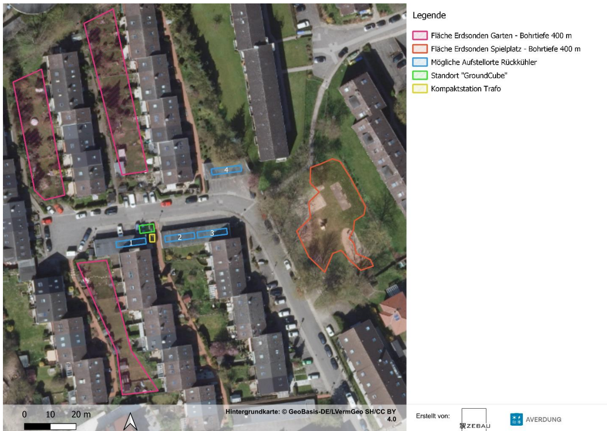
Abbildung 35: Mögliche Aufstellflächen für die Wärmeversorgung Variante 1
