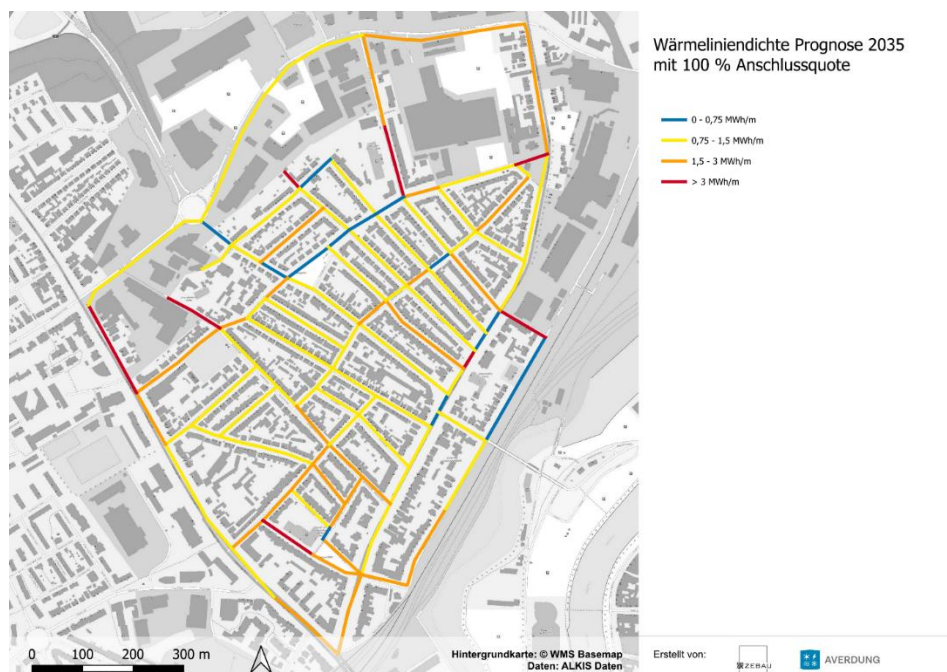
Abbildung 41: Wärmeliniedichte, Bedarfsprognose 2035, Anschlussquote 100 %
