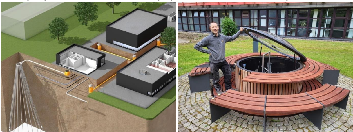
Abbildung 33: Schrägbohrtechnik (links) und zugehöriges Verteilerbauwerk (rechts) (vgl. 16 )
